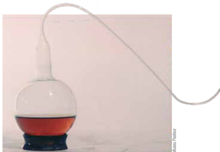
O balão pescoço de cisne era usado em experimentos de Pasteur
